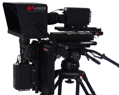
アクティブステレオカメラ BinoQ-P4B (Bi2-Vision社製)
